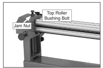
Figure 29. Hex bolt and jam nut.
